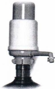
Механическая помпа для бутилированной воды работает по принципу механического насоса. Она надевается на горлышко бутыли и подает воду при нажатии кнопки. Она не нагревает и не охлаждает воду. Электропитание и дополнительные приспособления не требуются.
